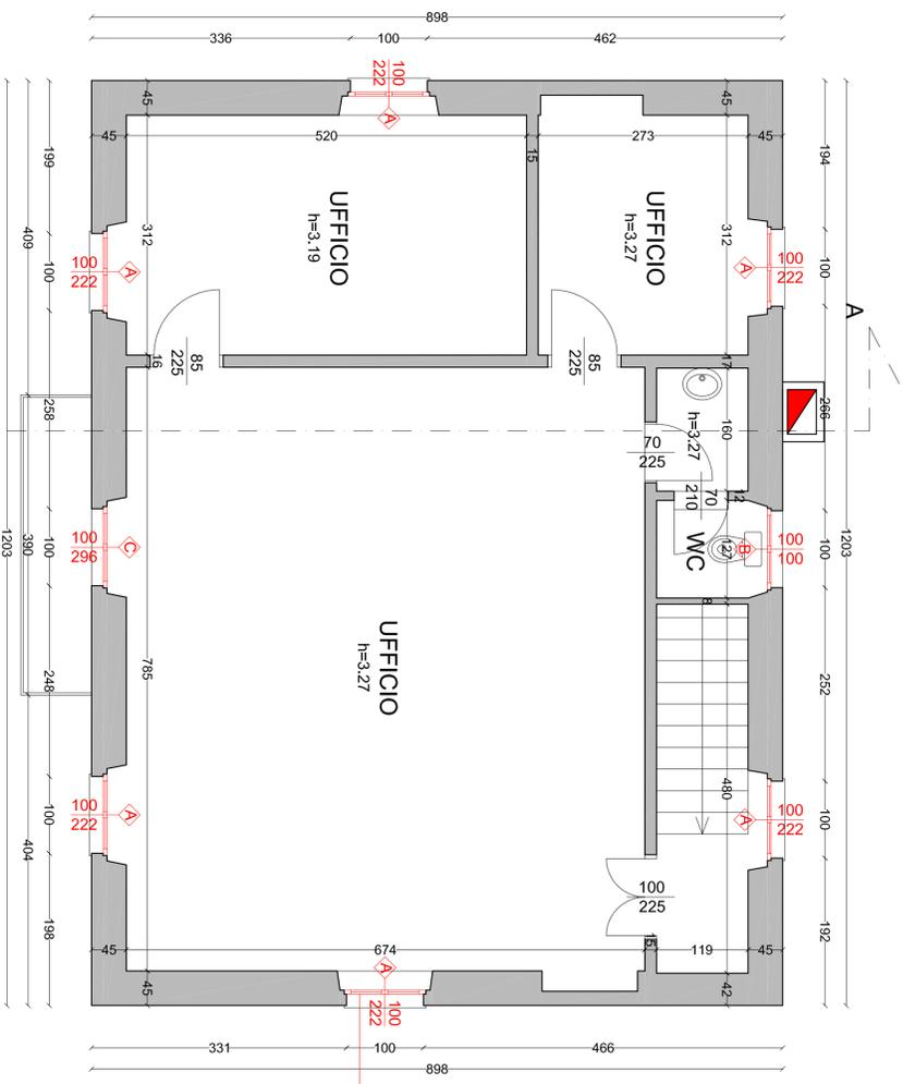
Sostituzione serramenti con nuovi in legno
